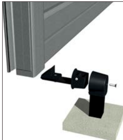
Détail de pose et réglage possible de l'arrêt d'ouverture
