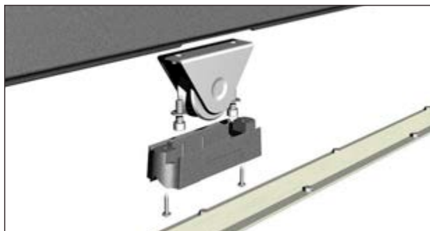
Détail du rail et de l'ensemble roulette et cache-roulette pour coulissant
